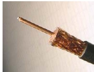
**Figure 1 :** Structure d'un câble coaxial
