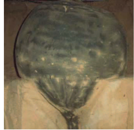
Vue d'une incorporation de mortier dans du sable fin
