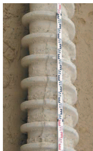
T-PILE - Augmentation des performances des pieux par rainurage
