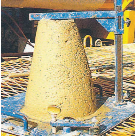
Contrôle du slump
