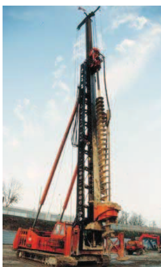
STARSOL - Tarière continue à tube plongeur et enregistrement continu des paramètres
