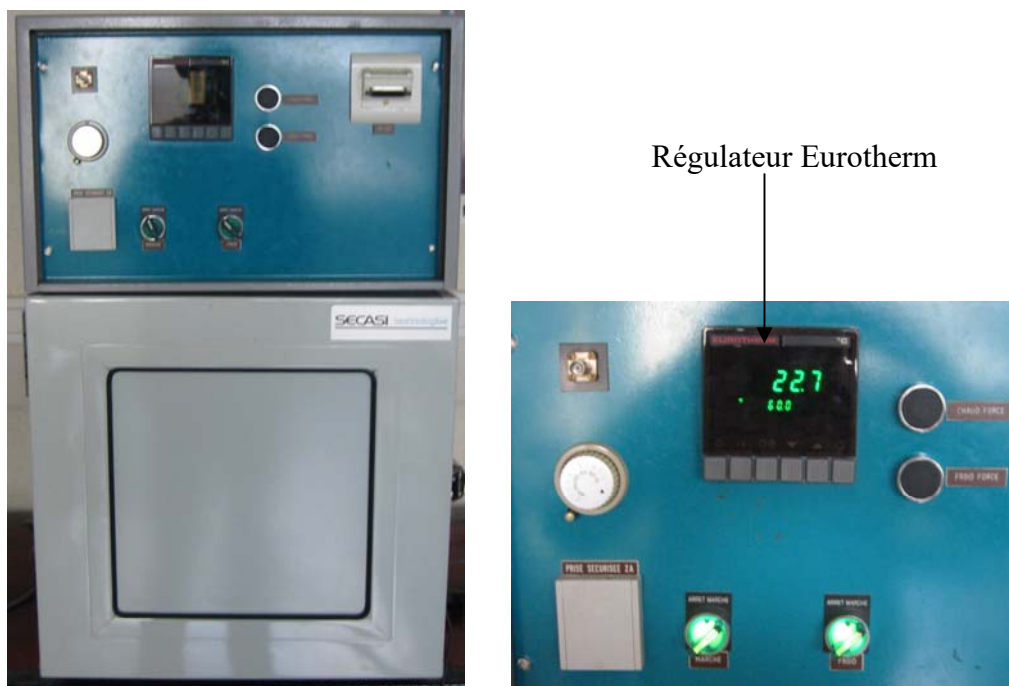
Figure 1 – Photographie de l'enceinte climatique
