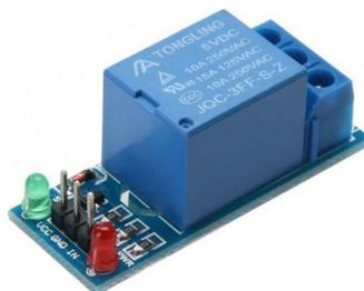
Ce relais sera branchée sur la pin 13. Lorsque celle-ci sera passée à HIGH, le relais va s'activer (on entend distinctement un "clac") afin de fermer le circuit électrique de notre lampe de bureau.
