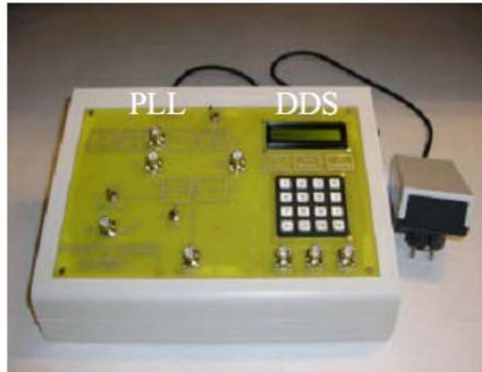
Figure 3 : Photo de la maquette synthèse de fréquences par PLL et DDS
