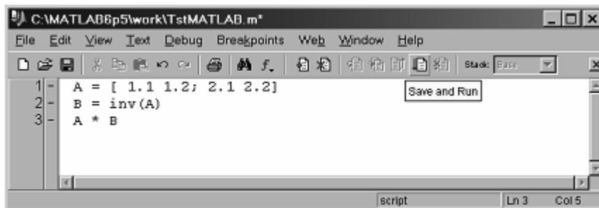
L'exécution du script (les commandes une après une) se fait à l'aide du bouton Save and Run ou avec le menu debug/Save and Run ou bien, simplement, en appuyant sur la touche fonction F5. Les résultats d'exécution sont affichés dans la fenêtre des commandes de la même manière que si les commandes sont entrées dans cette fenêtre.
