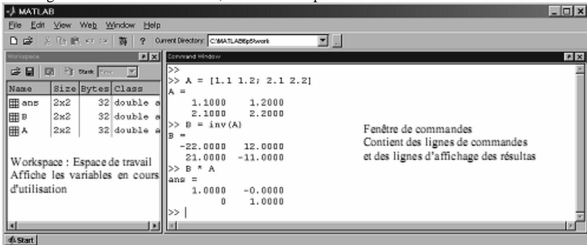
Les déclarations et les commandes peuvent être introduites ligne par ligne dans la fenêtre des commandes ou sous forme d'un script dans un éditeur qui peut être évoqué par la commande edit.
