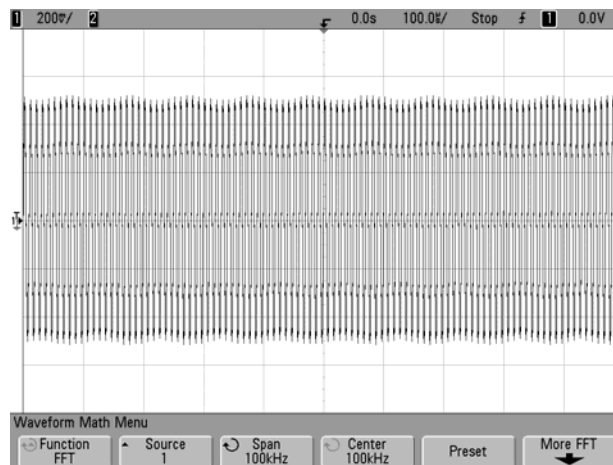
Figure 3 : Signal modulé en amplitude pour le test de résolution, f_p = 100\text{kHz} , m = 2\% et F = 10\text{kHz}
