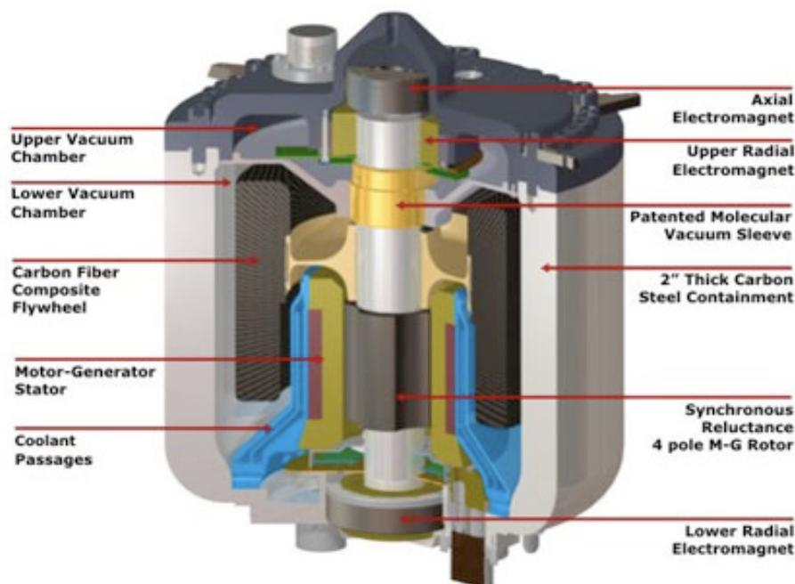
Le système est composé d'un volant d'inertie, d'un moteur/générateur et d'un onduleur de tension réversible en courant. Pour des raisons de sécurité et pour limiter les pertes par ventilation, le volant est placé dans une enceinte à vide. De plus, les pertes par frottements mécaniques sont réduites par l'utilisation de paliers magnétiques.
