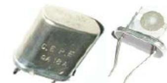
Le quartz est un oxyde de silicium cristallin qui est isolant et piézoélectrique
