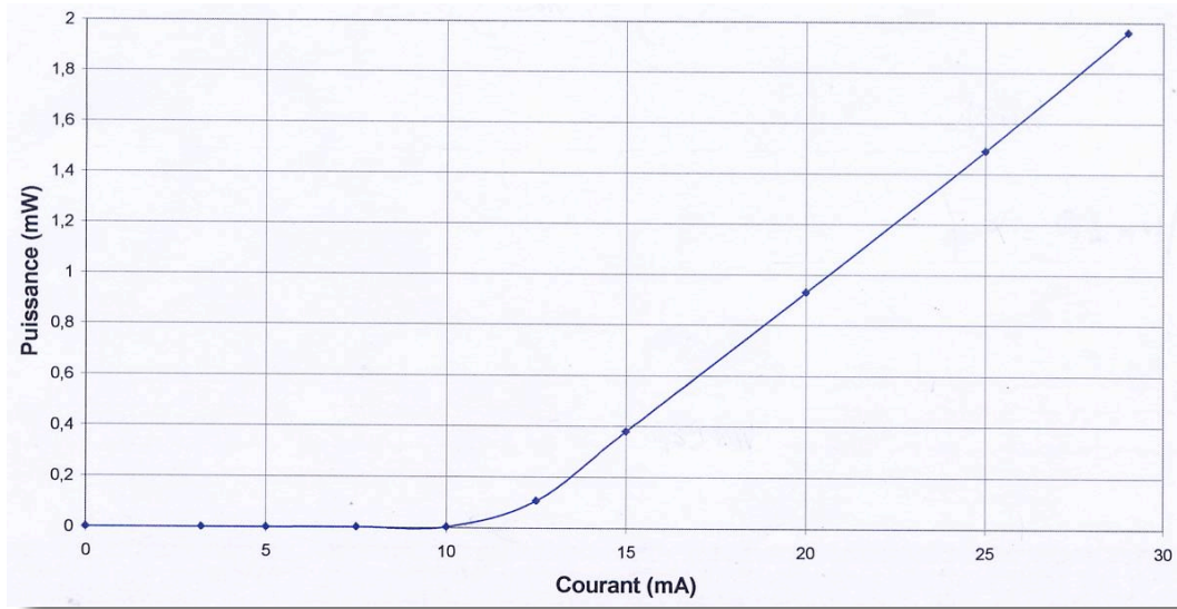
Figure 2 : Caractéristique P_{opt}(I) de la diode Laser multimodes à 1310nm en fonction du courant I d'alimentation
