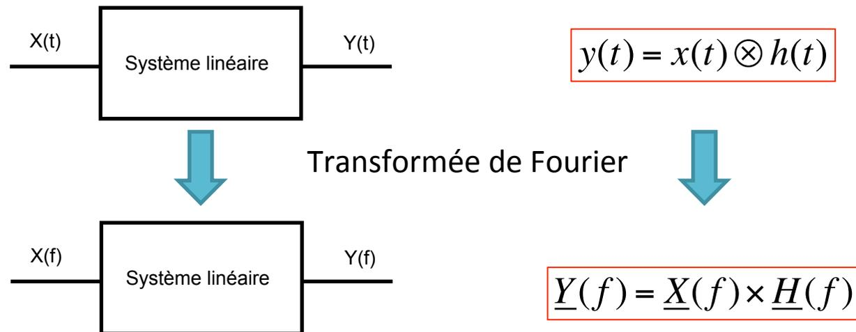
On montre assez facilement que le produit de convolution dans le temps se transforme en produit simple
