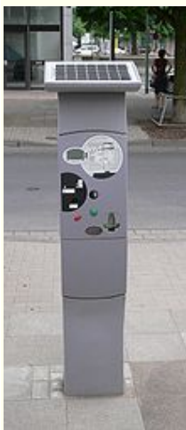
Horodateur alimenté par un panneau solaire photovoltaïque
