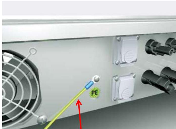
« La masse de l'onduleur doit être reliée à la liaison équipotentielle par un conducteur de section minimale égale à 6 mm<sup>2</sup> Cu ou équivalent, et au conducteur de protection de la partie AC. »
