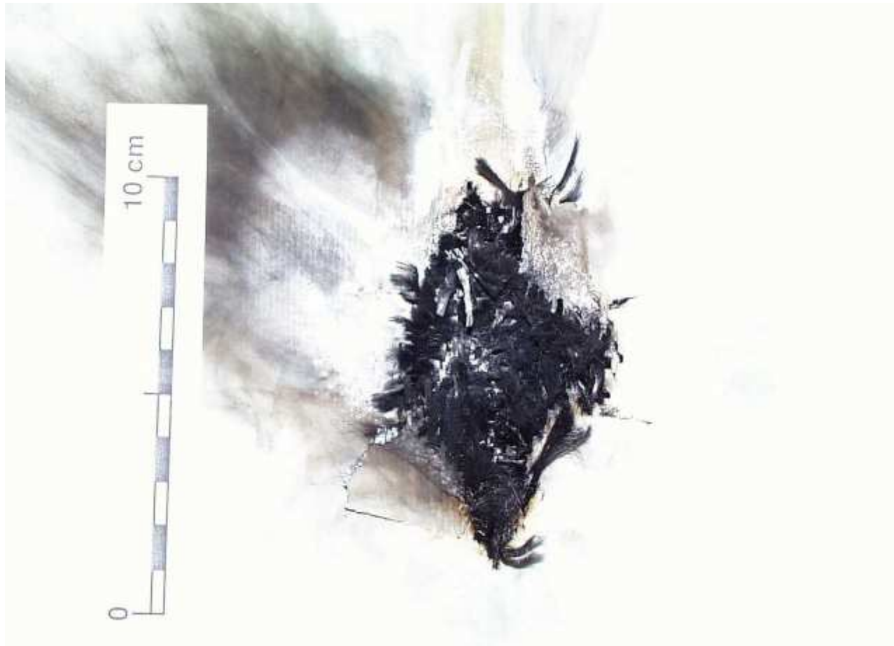
Impulsions type D+C* sur un composite en fibres de carbone
