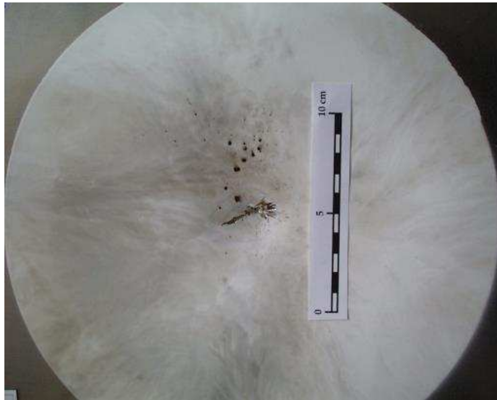
Effet d'onde de choc sur un panneau en aluminium peint
