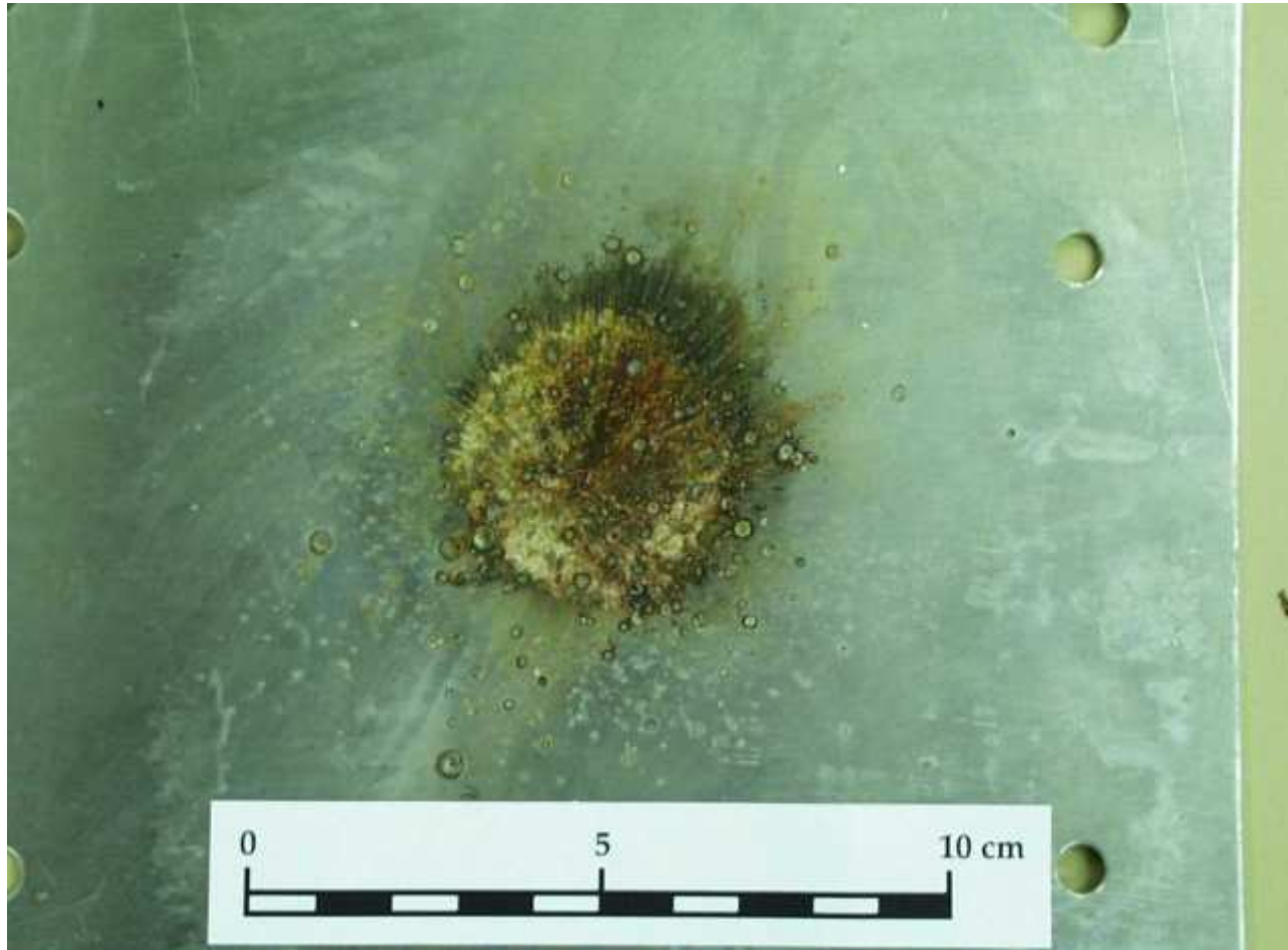
Composante impulsionnelle A sur alliage d'aluminium
