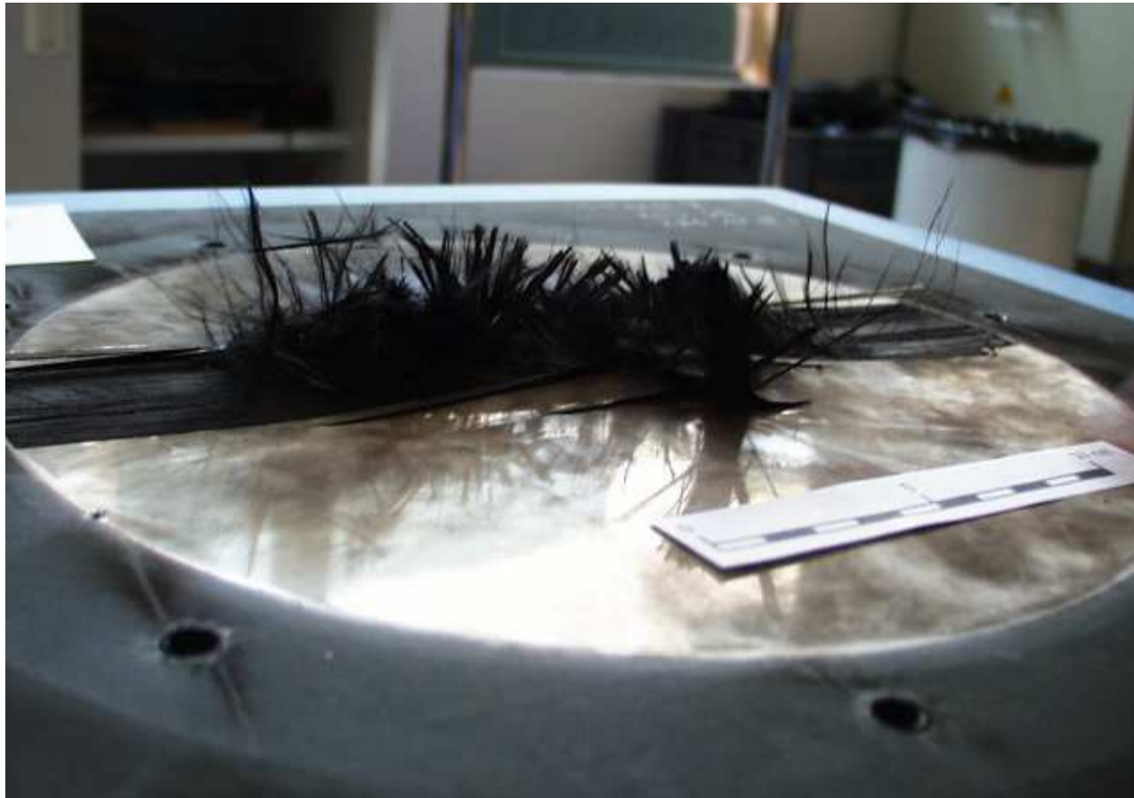
Impulsion type A sur composite à fibre de carbone non protégé
