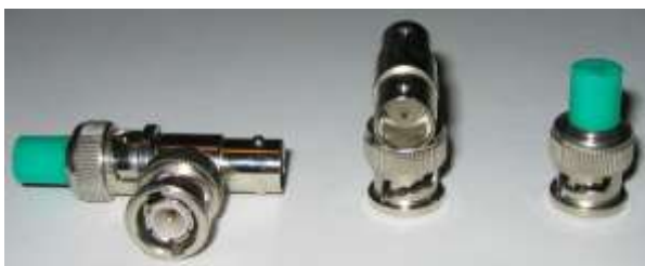
Figure 2 : Connecteurs BNC (Baby Neill-Concelman)
