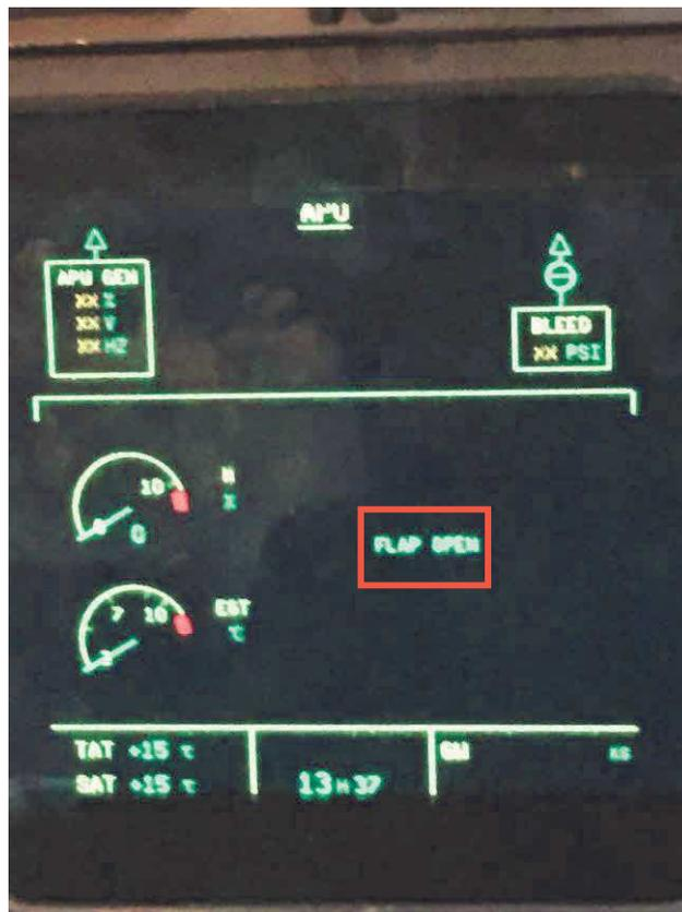
Vous pouvez appuyer sur le bouton « START » et vous allez voir le bouton « ON » s'allumer et les aiguilles des 2 indicateurs de l'ECAM vont commencer à monter.
