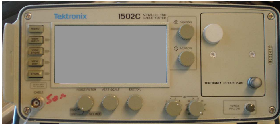
Figure 3. Face avant du réflectomètre Tecktronic 1502C
