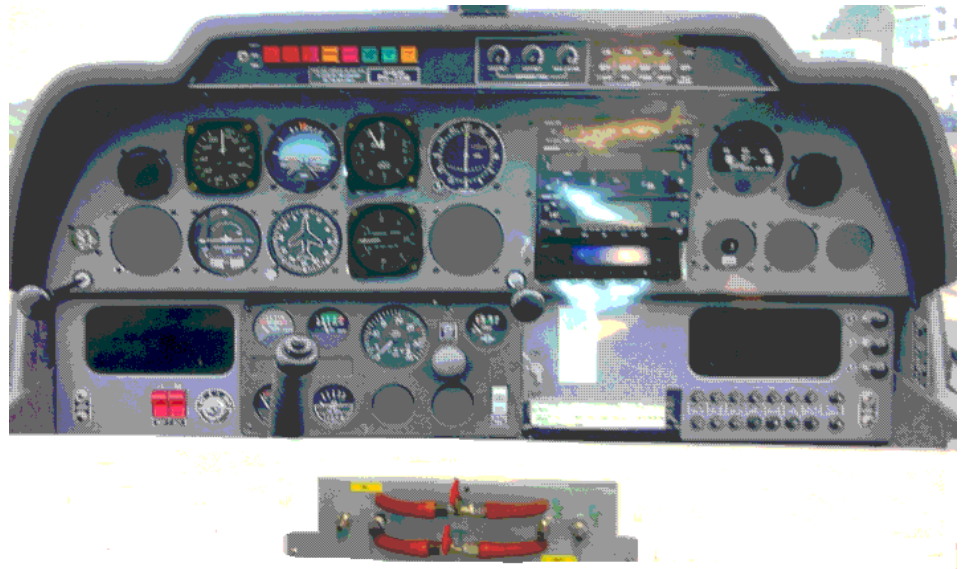
Valise de test anémo-barométrique ADSE743:
