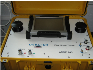
Valise de test anémo-barométrique ADSE743:
