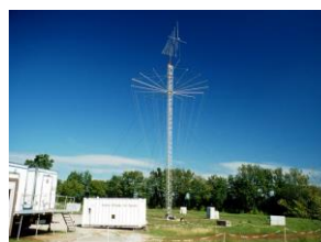
Antenne large bande pour tests électromagnétiques
