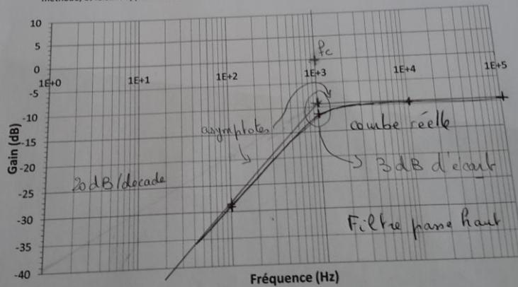
Figure 4 : Diagramme de Bode du Gain en dB de la fonction de transfert  $T(f)$ .
