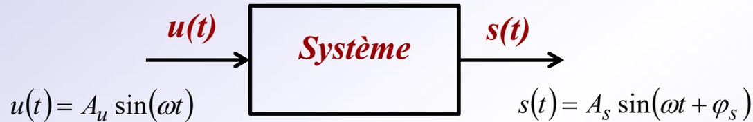
**Sous l'hypothèse d'un système linéaire stationnaire, la sortie du système est alors, en régime permanent, un signal sinusoïdal de pulsation  $\omega$ , d'amplitude  $A_s$  et de déphasage  $\varphi_s$ .**
