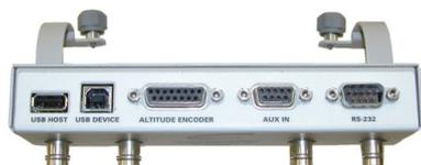
Branchez la clef USB et allumez l'IFR 6000. Il doit détecter la clef USB et commencer par vérifier l'intégrité des fichiers. Il installera ensuite automatiquement la nouvelle version.
