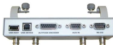
Il se fixe sur l'IFR 6000. Il permet d'accéder aux interfaces RS232 (pour le transfert des résultats dans un ordinateur) et USB. (pour remettre à jour le logiciel de l'IFR 6000)
