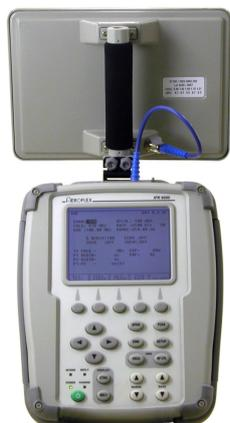
Orientez l'antenne de l'IFR 6000 vers l'antenne du transpondeur. Mesurez précisément les distances verticales et horizontales entre antennes. Appuyez sur la touche XPDR pour retrouver l'écran XPDR-AUTO TEST. Sélectionnez
