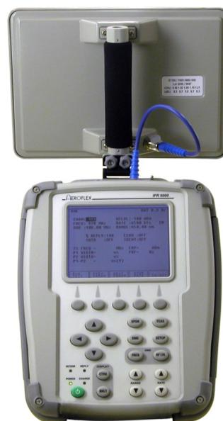
Orientez l'antenne de l'IFR 6000 vers l'antenne du transpondeur. Mesurez précisément les distances verticales et horizontales entre antennes. Appuyez sur la touche XPDR pour retrouver l'écran XPDR-AUTO TEST. Sélectionnez l'antenne basse (BOTTOM) à l'aide de la touche logicielle SELECT ANT.
