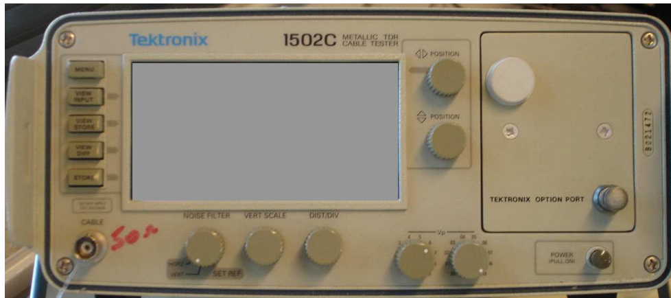
Figure 3. Face avant du réflectomètre Tecktronic 1502C
