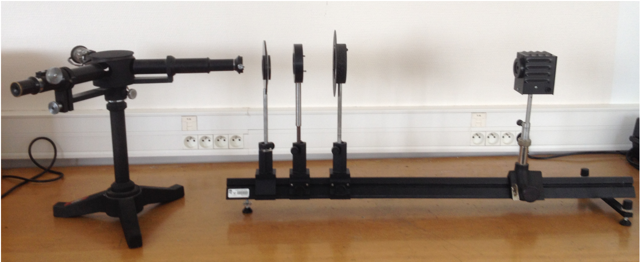
Figure 5 : montage du spectroscope et du banc optique pour l'observation du spectre cannelé.
